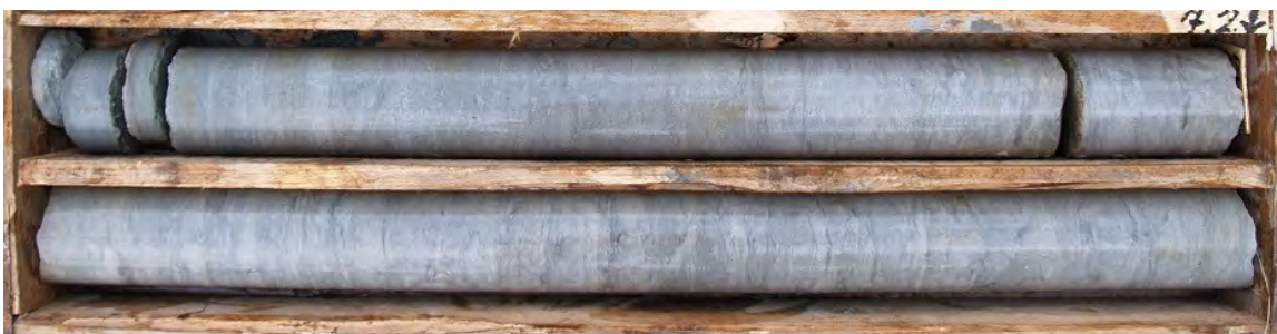
Joonis 7. Nehatu uuringuruumi dolokivi on sageli massiivse tekstuuriga, puursüdame tulpade pikkus ulatub 1 meetrini (pa 7).
