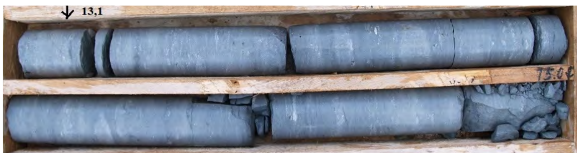
Joonis 10. Uuringuruumi alumises osas lasub väga savikas dolokivi.
