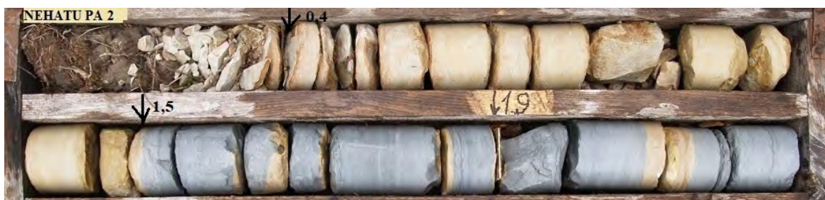
Joonis 6. Nehatu uuringuruumi läbilõike ülaosas lasub hallikaskollane mikrokristalliline dolokivi.
